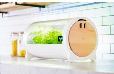
『foop』は、日本初のスマートフォン連動型のIoT水耕栽培機で、日々の野菜栽培の状況について複数のセンサーが検出する環境データを専用アプリで確認することが可能であり、野菜毎の育成（レシピ）機能により、クラウド技術を通じてユーザーの野菜栽培をサポート、栽培を成功に導くさまざまな機能を備えた「インテリア野菜コンピュータ」です。
